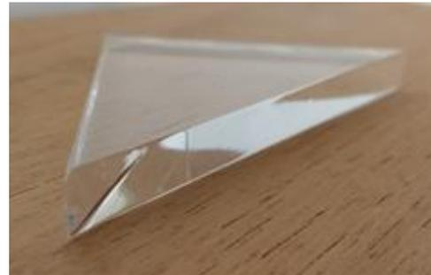
**Figura 17:** Prisma triangular de 45° (prisma de reflexão total)
