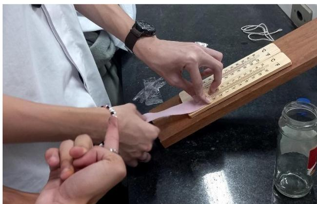
**Figura 8:** Alunos montando termohigrógrafo
